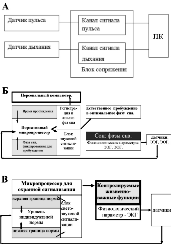
Рис. 1. Структура информационно-аппаратурного комплекса для контроля физиологических функций во время повседневного ночного сна: блок корреляционного анализа сердечного ритма и частоты дыхания (А); блок контроля и анализа фаз сна, пробуждения в выбранную фазу сна прерывания опасной фазы сна (Б); блок охранной сигнализации нарушения сердечного ритма (В).
